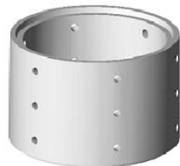
BUSE DE PUIITS A EMBOITEMENTS Ø Int. 0,80 m Ht. 0,60 m - PERFOREE
